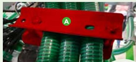
(A) **Blocage réglable des tuyaux d'injection** pour les protéger de l'usure due aux vibrations.
